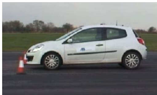
ロボットは減速度を制御して、指定したポイントへ車両を停止させることができます
