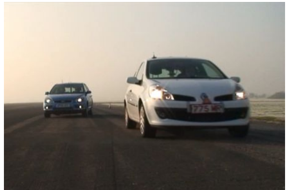
ロボットで制御されている2台の車両を利用した追い越し試験
